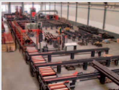
Линия по консервации труб
