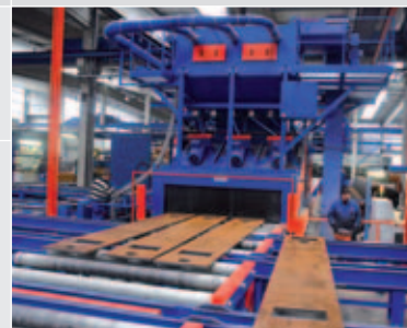
Рольганговая дробемётная установка
