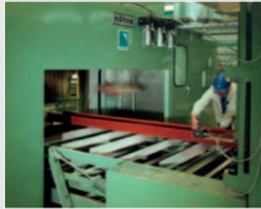
Выходная зона покрасочной установки
